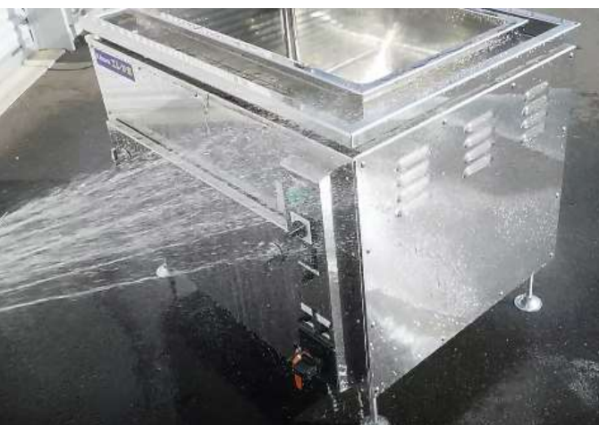
防水試験状況 散水しても内部の電気部品には影響のないことを確認しました。 (動画より抜粋)
